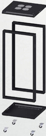
* Tekerlekler Taban sacına montajlanır. * Çatı ve taban sacları Gövde dikmeleri ile birleştirilir. * Wheels are mounted on the base sheet * Roof and base sheets are combined with body Frames
